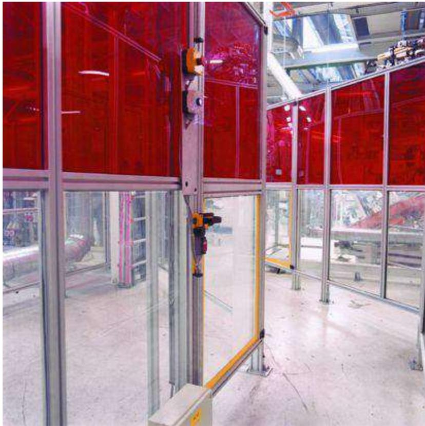
Cerramiento con policarbonato anti soldadura
